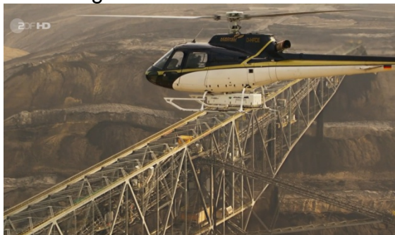
Abb. 5: Helikopter mit MILAN-ALS-Messeinheit, Tagebau Welzow-Süd
