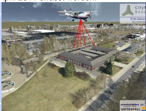
Abb. 4: 3 D-Industriemodell Schwarze Pumpe erfasst & produziert mittels ALS, TLS, RGB, CAD-Modellen
